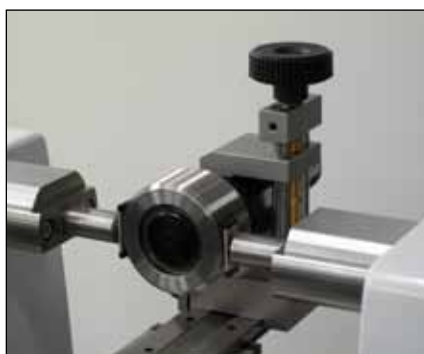
Etalonnage de tampons filetés (3P/0.17-3.2/S6.5/TA-SU-315)
