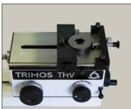
Etalonnage de bagues lisses (THV-260)
