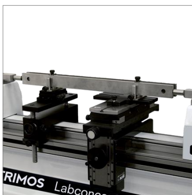
Contrôle comparatif de cales- étalons > 250 mm (TA-SU-313, TELMA7/P, TA- SU-305, TA-SU-306)
