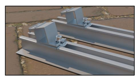
Achten Sie darauf, dass die Erdungsplatte zwischen Stütze und Schiene sitzt. Eventuell müssen Sie die Schraube dafür etwas herausdrehen.
