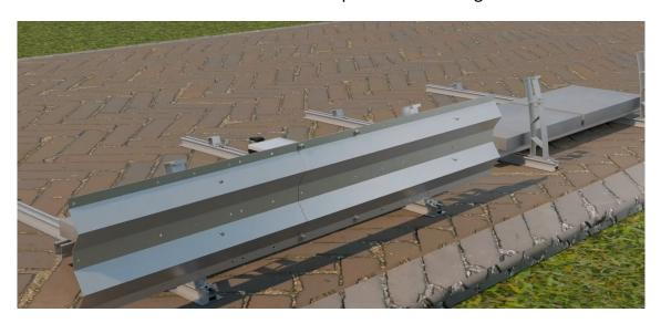
Verbinden Sie zwei Windabweiserbleche mit den Flanschschrauben und Flanschmuttern. Bei Modulen mit einer Länge von 1722 mm überlappen sich die Windabweiserbleche an zwei aufeinanderfolgenden Lochreihen, bei Modulen mit einer Länge von 1955 mm nur an der ersten Lochreihe
