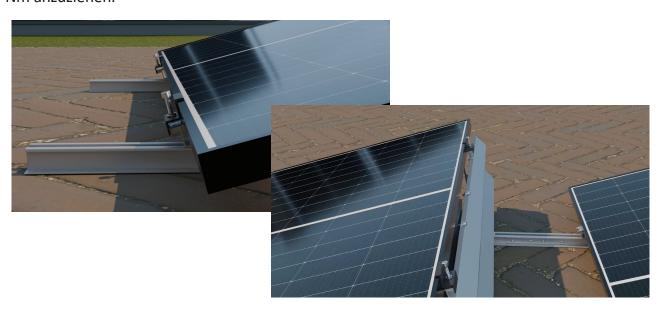
Sollten die Modulklemmen an den großen Stützen einen Spalt zum Modulrahmen aufweisen, dann müssen Sie die großen Stützen an der Basisschiene lösen und jeweils so korrigieren, dass der Spalt geschlossen wird. Anschließend können Sie die großen Stützen wieder mit 18 Nm festschrauben und die Modulklemmen an den großen Stützen mit 16 Nm anziehen. Wenn Sie alle acht Endklemmen fest angezogen haben ist ihr System bereit Strom zu produzieren.
