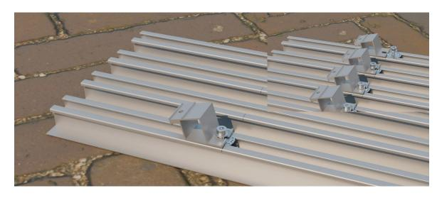
Achten Sie darauf, dass die Erdungsplatte zwischen Stütze und Schiene sitzt. Eventuell müssen Sie die Schraube dafür etwas herausdrehen.
