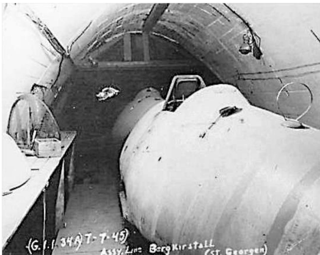
El fusellatge d'un avió Messerschmidt Me-262 a mig construir, dins d'un dels túnels del "Bergkristall". Aquesta era la feina que realitzava Francisco Casares. Fotografia: U.S. Air Force Historical Research Agency.
