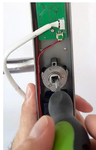
Rysunek 4. Odkręcanie śruby mocującej w celu zmiany położenia klamki (w zależności od typu drzwi: lewe – prawe)
