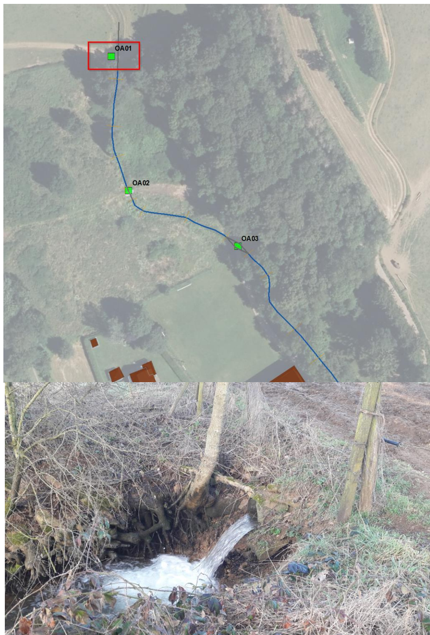
Figure 5-1-Localisation et vue sur l'ouvrage OA01 limitant la capacité d'écoulement à l'amont du secteur d'étude.
