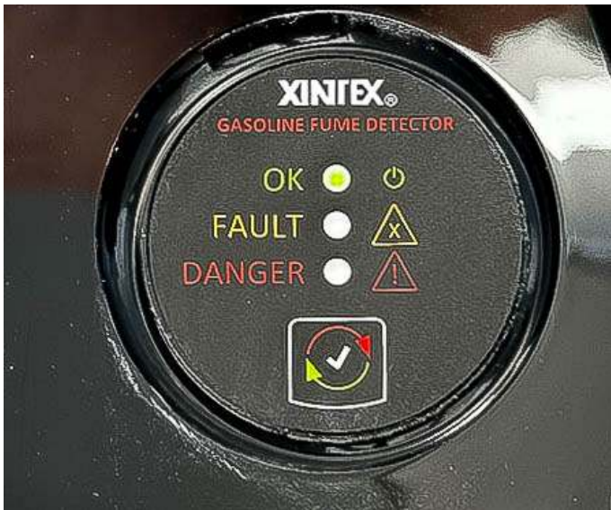
Gas vapor detector
