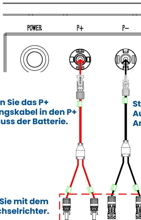
Stecken Sie das P+ Ausgangskabel in den P+ Anschluss der Batterie.
