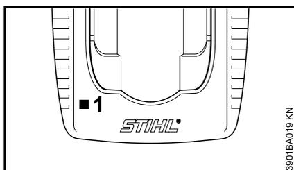
Nach dem Anschließen des Ladegerätes an die Stromversorgung findet ein Selbsttest statt. Während dieses Vorganges leuchtet die LED (1) am Ladegerät für ca. 1 Sekunde grün, dann rot und erlischt wieder.
