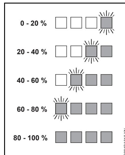
Ist der Ladevorgang beendet, schalten sich die LEDs am Akku automatisch aus.
