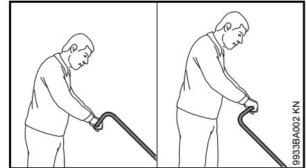
Abhängig von der Körpergröße des Benutzers kann der Schubbügel in 2 unterschiedlichen Positionen montiert werden.
