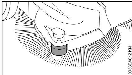
De zijgeleiderol vergemakkelijkt de besturing van het apparaat langs randen, bijv. langs muren of trottoirs.
