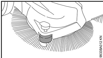
Il rullo laterale facilita la guida dell'apparecchiatura nelle zone perimetrali, ad es. lungo pareti o cordoli.
