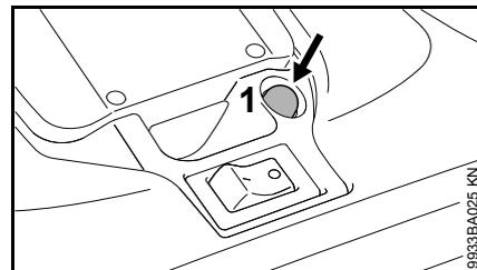
Terwijl de temperatuurafhankelijke overbelastingsbeveiliging van de schotelbezem automatisch wordt gereset, moet de overbelastingsbeveiliging van de bezemrol handmatig worden gereset door op de schakelaar (1) te drukken.
