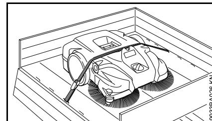
Gerät mit einem Spanngurt gegen Verrutschen sichern.
