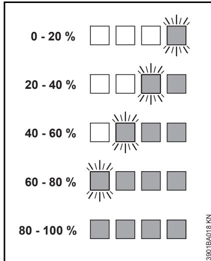
Terminato il processo di carica, i LED della batteria si spengono automaticamente.
