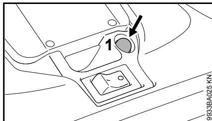
Mentre la protezione contro i sovraccarichi termici delle spazzole si resetta automaticamente, la protezione del rullo deve essere resettata manualmente premendo l'interruttore (1).
