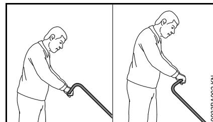
Afhankelijk van de lichaamsgrootte van de gebruiker kan de duwbeugel in 2 verschillende standen worden gemonteerd.
