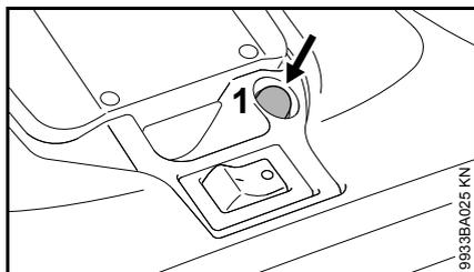
Während sich der temperaturabhängige Überlastschutz der Tellerbesen wieder automatisch zurücksetzt, muss der Überlastschutz der Kehrwalze durch Drücken auf den Schalter (1) manuell zurückgesetzt werden.
