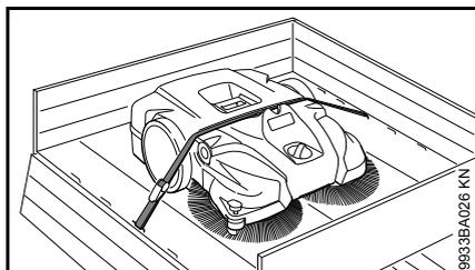
Attacher la machine avec une sangle pour qu'elle ne risque pas de se déplacer.
