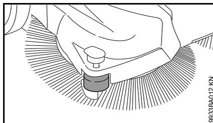
Le galet latéral facilite le guidage latéral de la machine, par ex. le long des murs ou des bordures de trottoir.
