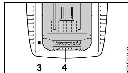
Nach dem Einsetzen des Akkus leuchtet die LED (3) am Ladegerät – siehe "LED am Ladegerät".
