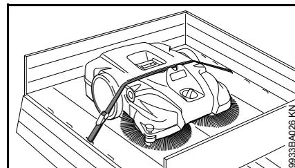
Het apparaat met een spanriem vastzetten zodat dit niet weg kan glijden.
