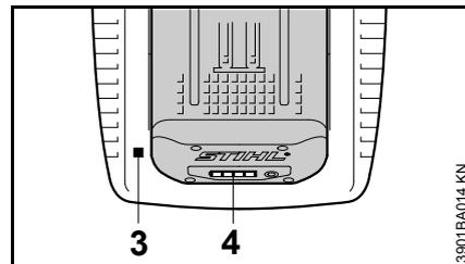
Na het aanbrengen van de accu brandt de led (3) op de acculader – zie "Led op de acculader".
