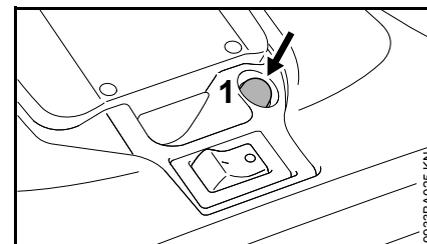
Tandis que le disjoncteur de surcharge thermique des balais rotatifs est réinitialisé automatiquement, il est nécessaire de réinitialiser manuellement le disjoncteur de surcharge thermique du rouleau brosse en appuyant sur l'interrupteur (1).
