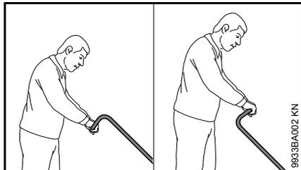
Suivant la taille de l'utilisateur, le guidon peut être monté dans 2 positions différentes.
