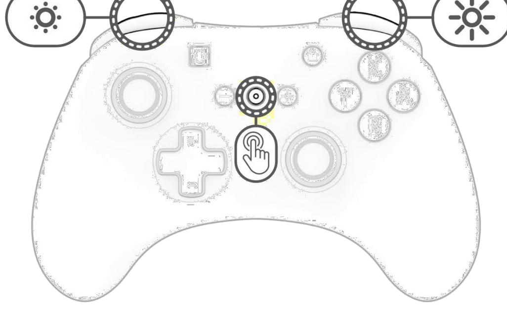
A. Aby wyregulować jasność diody LED, przytrzymaj przycisk „funkcja” i naciśnij przycisk ZL albo skieruj D-pada w dół, aby zmniejszyć jasność, lub naciśnij przycisk ZR albo skieruj D-pada w górę, aby zwiększyć jasność.
