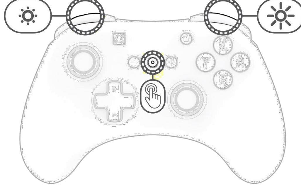
A. Para ajustar o brilho do LED, mantenha premido o botão “função” e prima ZL ou o botão D-pad para baixo para diminuir a luminosidade, ou ZR ou o botão D-pad para cima para aumentar a luminosidade.
