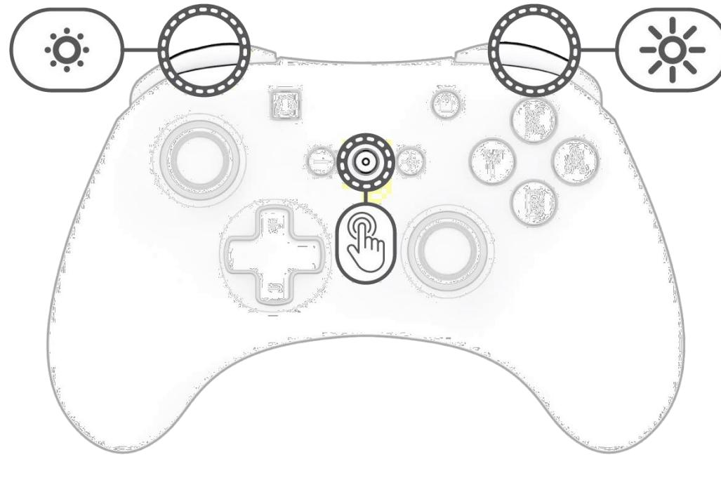
A. Pour régler la luminosité de la DEL, maintenez le bouton « Fonction » enfoncé et appuyez sur le bouton ZL ou le bouton vers le bas du D-Pad pour diminuer la luminosité, ou sur le bouton ZR ou le bouton vers le haut du D-Pad pour augmenter la luminosité.
