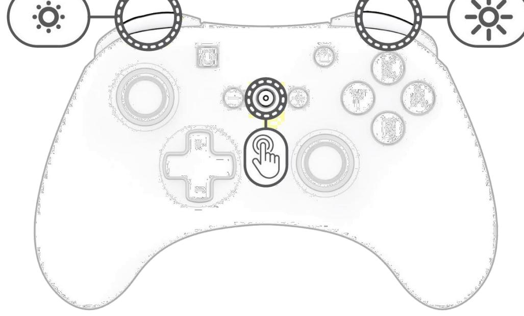
A. Pour régler la luminosité de l'éclairage LED, maintenez le bouton « Fonction » enfoncé et appuyez sur ZL ou sur le bouton de commande vers le bas du D-Pad (de la croix directionnelle) pour diminuer la luminosité, ou sur ZR ou le bouton de commande vers le haut du D-Pad (de la croix directionnelle) pour l'augmenter.
