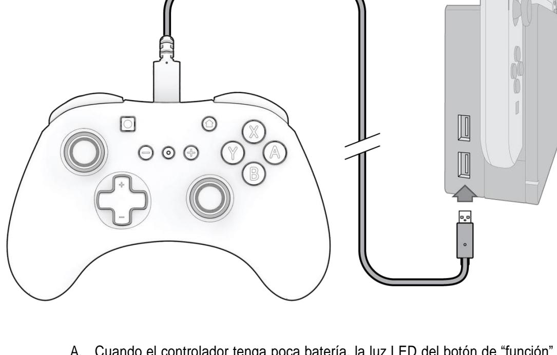
A. Cuando el controlador tenga poca batería, la luz LED del botón de “función” (ubicada en la parte inferior central del controlador entre los botones + y -) parpadeará en ROJO cada 30 segundos.
