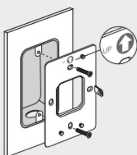
2. Fissa l'AP alla staffa. Alcuni modelli possono avere un foro a vite per fissare ulteriormente il prodotto tramite vite.
