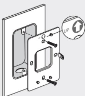
2. Conecte el AP al soporte. Algunos modelos pueden tener un orificio para tornillos para asegurar aún más el producto mediante tornillos.
