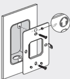
2. Fixe o PA ao suporte. Alguns modelos podem ter um orifício para parafuso para fixar ainda mais o produto através de um parafuso.
