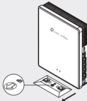
2. Placer AP'en lodret på en vandret overflade (såsom et skrivebord eller en hylde), der er uden for børns rækkevidde.
