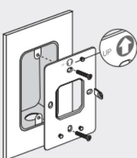
2. Fastgør AP'en til beslaget. Nogle modeller kan have et skruehul for yderligere at sikre produktet via skrue.
