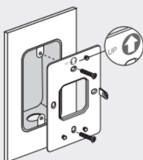
2. Fäst AP:n på konsolen. Vissa modeller kan ha ett skruvhål för att säkra produkten ytterligare med skruvar.
