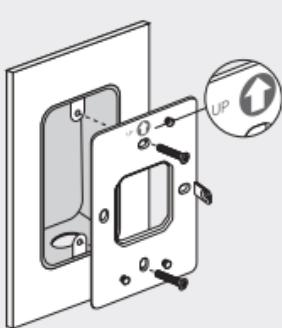
2. Fest AP til braketten. Noen modeller kan ha et skruehull for ytterligere å sikre produktet via skrue.
