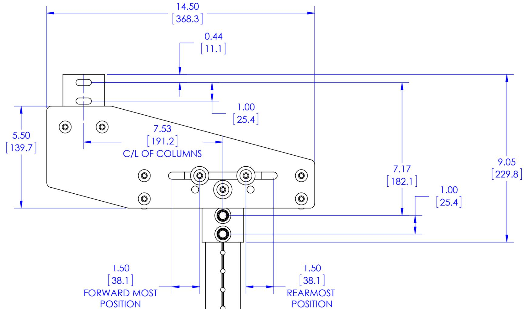
OFFSET SHOULD BE PUT IN THE FORWARD MOST POSITION FOR SCREENS LESS THAN 2.5" DEEP
