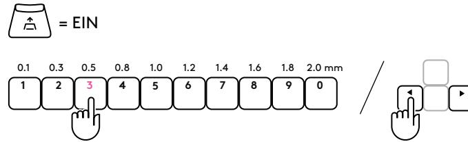
Drücke eine beliebige Buchstabentaste, um die aktuelle Empfindlichkeitseinstellung zu testen. Wenn du die Taste drückst und loslässt, leuchtet sie blau, wenn sie betätigt wird, und magentafarben, wenn sie zurückgesetzt wird.
