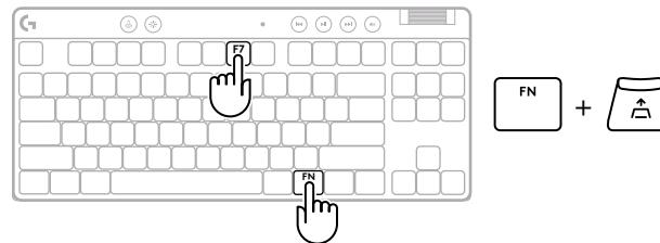
**3** Pritisnite F7, da omogočite vklop/izklop hitrega sprožilca.
