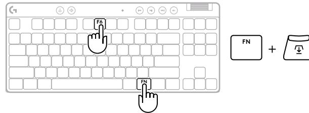
از کلیدهای جهت برای کمتر یا بیشتر کردن نقطه فعالسازی استفاده کنید. همچنین می‌توانید با فشار دادن عدد مناسب، مقدار مدنظرتان را مستقیماً انتخاب کنید (برای مثال "4" برای 1.5 میلی‌متر).
