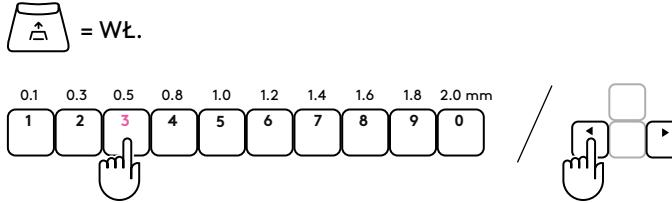
Naciśnij dowolny przycisk alfabetu, aby sprawdzić bieżące ustawienie czułości. Po naciśnięciu i zwolnieniu przycisku jego podświetlenie zmienia kolor na niebieski po uruchomieniu i purpurowy po zresetowaniu.
