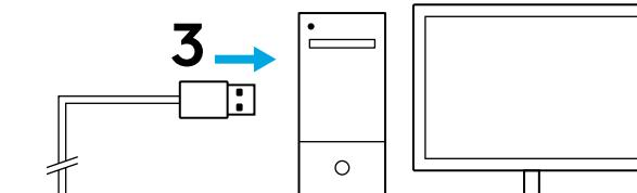
**3** Kabel povežite z računalnikom.
