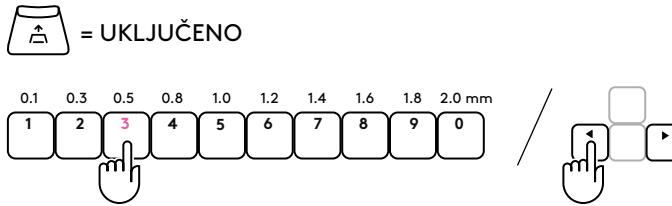
Pritisnite bilo koji taster slova da biste testirali aktuelno podešavanje osetljivosti. Kada se pritisne i otpusti, osvetljenje tastera pretvara se u plavo kada se aktivira, odnosno u purpurnocrvenu kada se resetuje.
