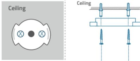
4. Lijn de groeven uit met de montageplaat en draai de eufy
