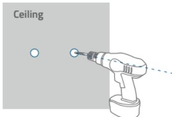
3. Alinee los orificios de la placa de montaje con los orificios taladrados en el techo. Inserte los tacos dentro de los orificios; es necesario utilizar los tacos en paredes que están hechas con materiales duros, como hormigón, ladrillo o estuco. Apriete los tornillos con un destornillador Phillips para fijar la placa de montaje al techo.
