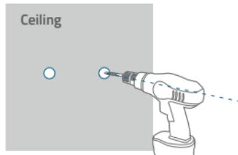
3. Alignez les trous sur la plaque de montage à ceux du plafond. Insérez les ancrages dans les trous ; les ancrages sont nécessaires pour les murs faits de matériaux durs tels que le béton, la brique ou le stuc. Fixez les vis avec un tournevis cruciforme pour fixer la plaque de montage au plafond.
