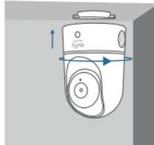
Zur Montage der eufy Indoor Cam an einer Wand empfehlen wir die Verwendung der Montagehalterung (nicht mitgeliefert) wie in der Abbildung unten dargestellt.
