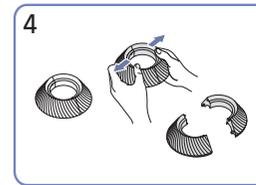
Disassemble the COVER-REAR TOP.
