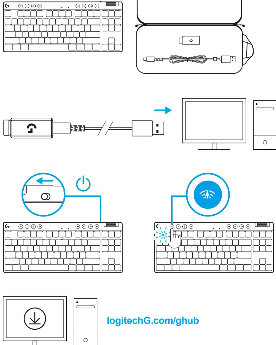
۲ گیرنده LIGHTSPEED را به همراه بسطدهنده و کابل در درگاه رایانه شخصی قرار دهید. در صورت تمایل، می‌توان گیرنده را بدون بسطدهنده و کابل، با قرار دادن مستقیم آن در درگاه USB استفاده کرد.
