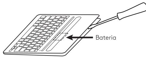
2. Desconecte a bateria da placa de circuitos e remova-a.
