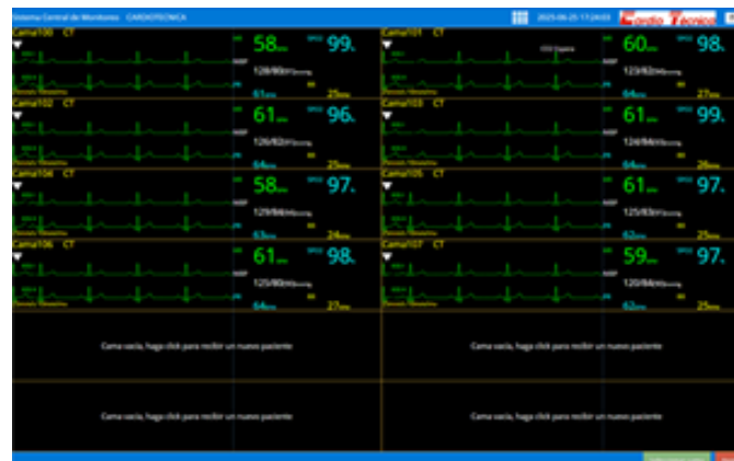
Figura 22 Configuración de distribución de 12 camas
