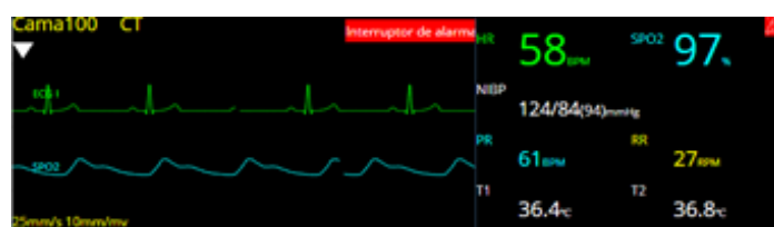
Figura 15a icono de interruptor de alarma
