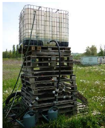
XXXX photo 170 : Ce prototype a tenu 5 ans en extérieur, plus longtemps que prévu. Il n'est pas raisonnable d'en faire une solution pour l'extérieur.
