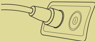
Collegare il cavo di ricarica alla presa magnetica di ricarica sull'interruttore di alimentazione.
