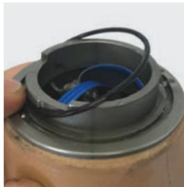
Installation du joint torique lubrifié.
