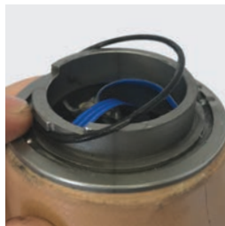
Installazione dell'O-ring lubrificato.
