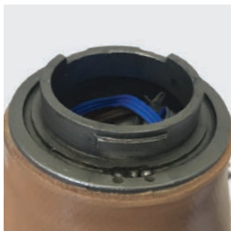
Anello di laminazione pulito pronto per la lubrificazione.
