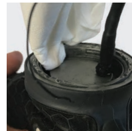
Pulizia dell'anello di laminazione.
