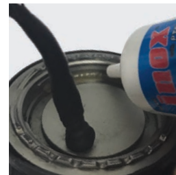
Applicazione del lubrificante nella scanalatura.
