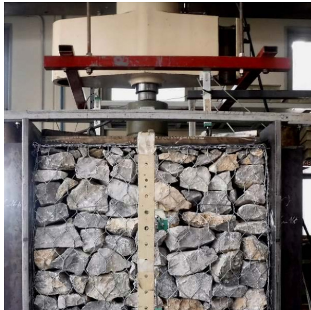
Prova di compressione in vera gran-
