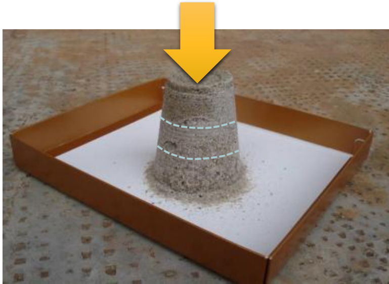
Arena compactada Restricción de movimiento lateral dado por las geomallas
