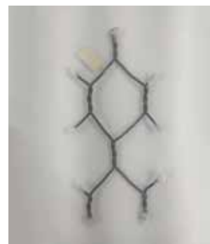
Échantillon, avant et après l'essai au brouillard salin (ISO 9227)
