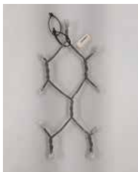
Échantillon, avant et après l'essai au brouillard salin (ISO 9227)
