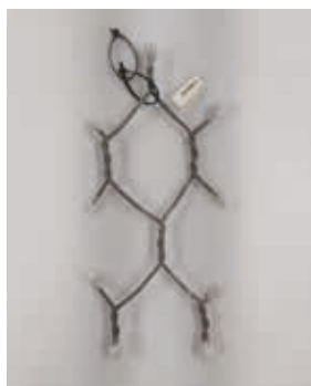
Ispitni uzorak, pre i posle testa slanim prskanjem (ISO 9227)
