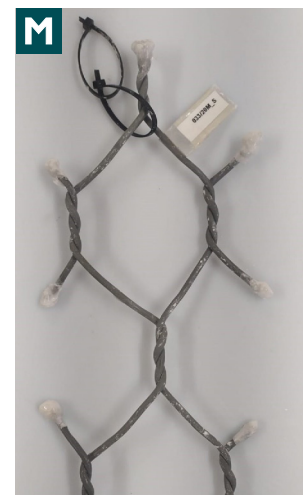
Mostra e provës, para dhe pas testit të spërkatjes me kripë (ISO 9227)
