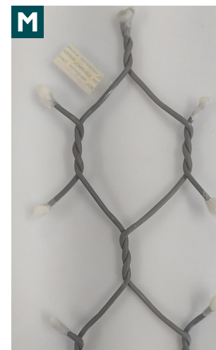
Mostra e provës, para dhe pas testit të spërkatjes me kripë (ISO 9227)
