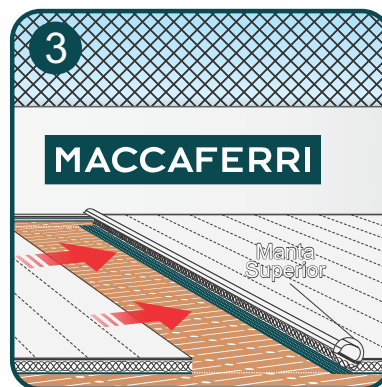
Colocação do painel subsequente do MacDrain® SF entre as abas do painel anterior
