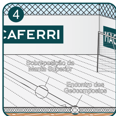
Fixação dos painéis de MacDrain® SF com a sobreposição do Geotêxtil superior
