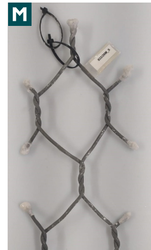
Δείγμα δοκιμής ASTM A975-21, πριν και μετά τη δοκιμή ψεκασμού άλατος (ISO 9227)
