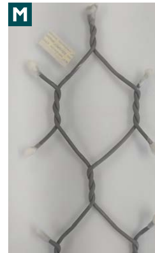
Δείγμα δοκιμής ASTM A975-21, πριν και μετά τη δοκιμή ψεκασμού άλατος (ISO 9227)
