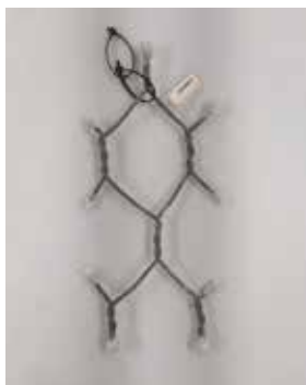
Échantillon, avant et après l'essai au brouillard salin (ISO 9227)
