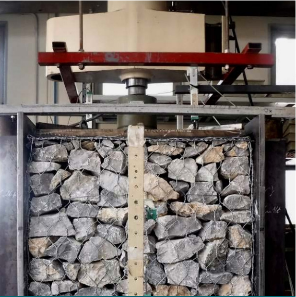
Ensayo de compresión a escala real
