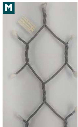
Provino del test, prima e dopo la prova in nebbia salina (ISO 9227)
