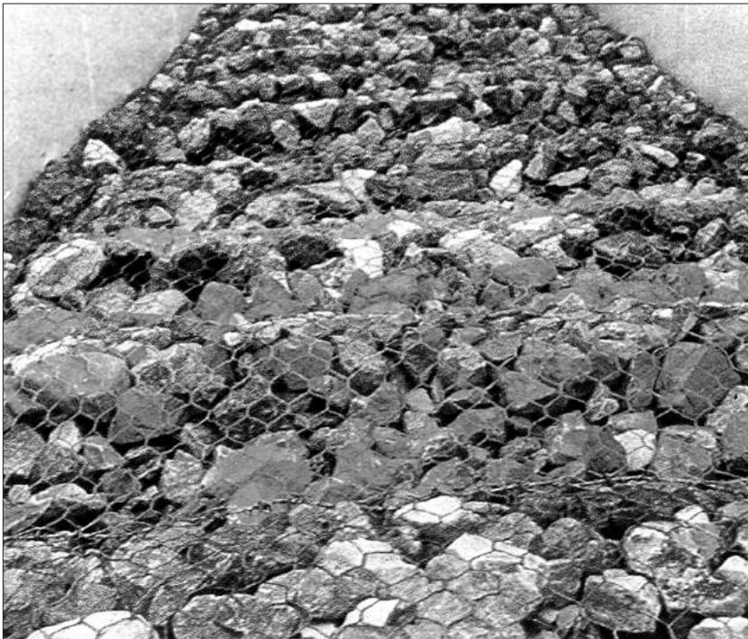
Figura 3.4.17 - Foto del movimiento de las piedras en el interior de las bolsas, durante un ensayo.
