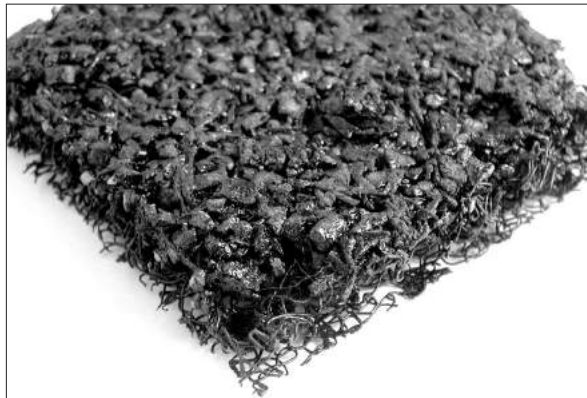
Figura 2.3.7 - MacMat ® S recubierto con emulsión asfáltica.
