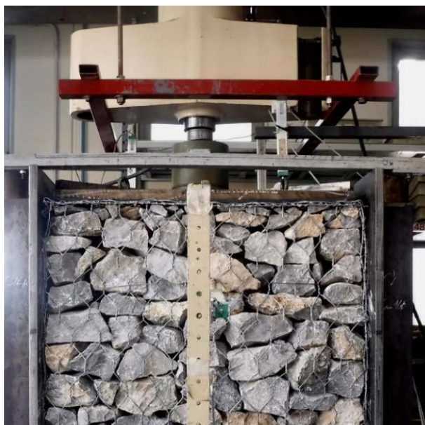
Veľkorozmerný test zaťaženie
