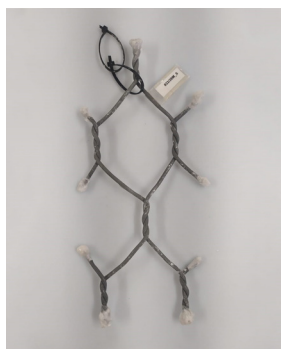
Testovacia vzorka po teste v komore v soľnej hmle (ISO 9227)
