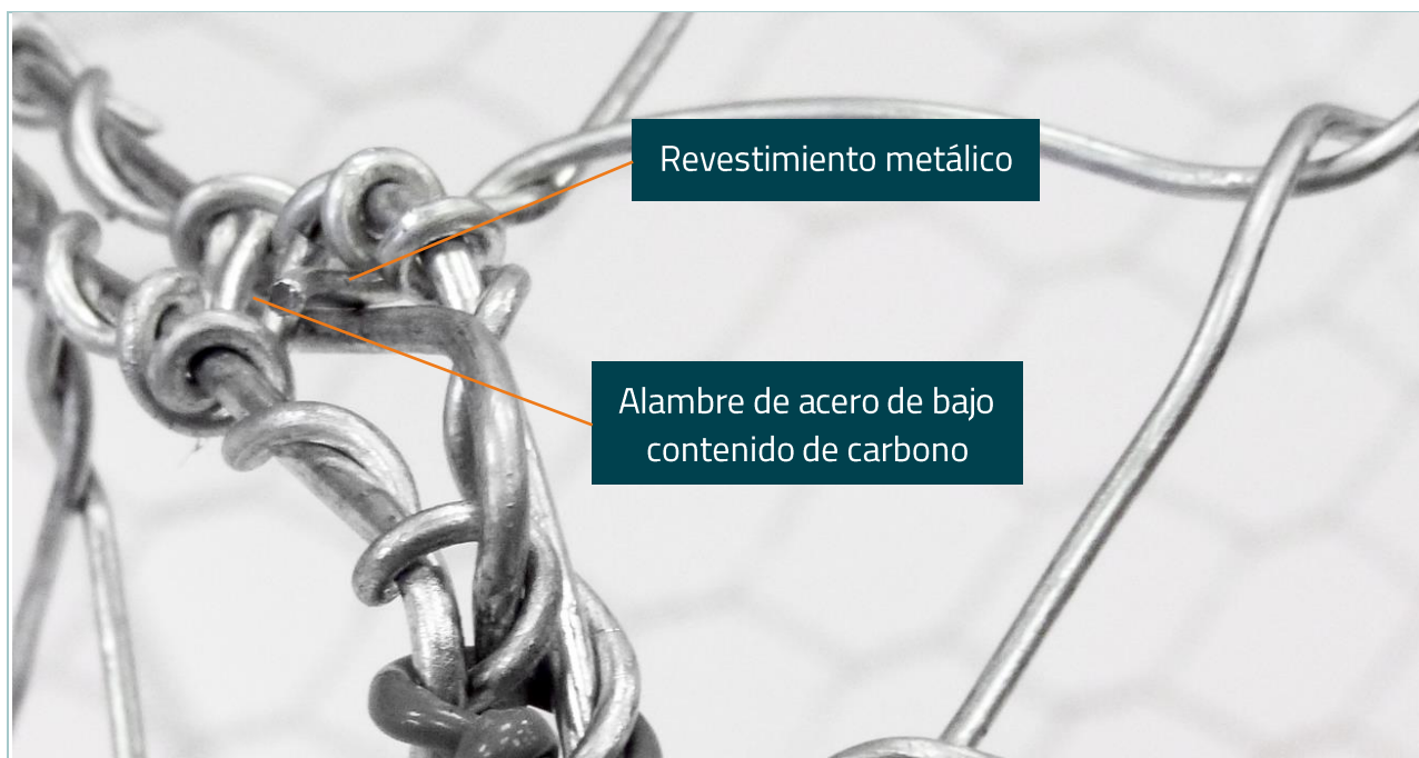
Figura 25 | Malla hexagonal de doble torsión compuesta de alambre de acero galvanizado con bajo contenido de carbono
