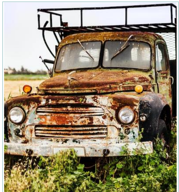
Figura 21 | Vehículo con carrocería metálica en proceso de corrosión atmosférica
