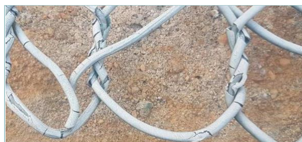
Figura 30 | Deterioro del revestimiento de PVC causado por la fotodegradación
