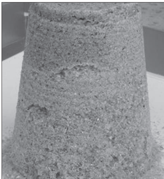
c) cono de arena con 3 capas de malla de polipropileno extraído de un vaso plástico.
