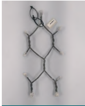
Test Numunesi, Tuz Sprey Testi (ISO 9227) öncesi ve sonrası
