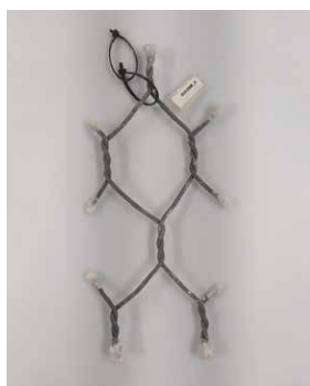
Muestra antes y después de la prueba de niebla salina (Salt Spray Test ISO 9227)
