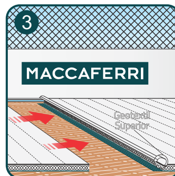
Colocación del siguiente geocompuesto MacDrain® SF entre las pestañas del anterior
