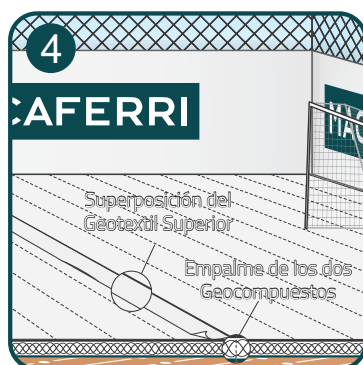
Fijación de los dos Geocompuestos, superposición del Geotextil superior
