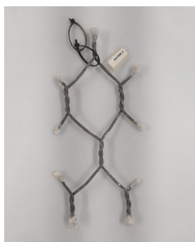
Prüfmuster, vor und nach dem Salzsprühnebeltest (ISO 9227)
