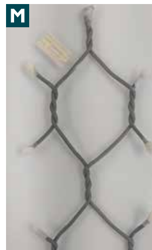
Échantillon d'essai, avant et après l'essai au brouillard salin (ISO 9227)
