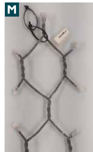
Échantillon d'essai, avant et après l'essai au brouillard salin (ISO 9227)
