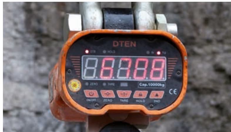
2 : Dynamomètre pour peser le bloc d'essai
