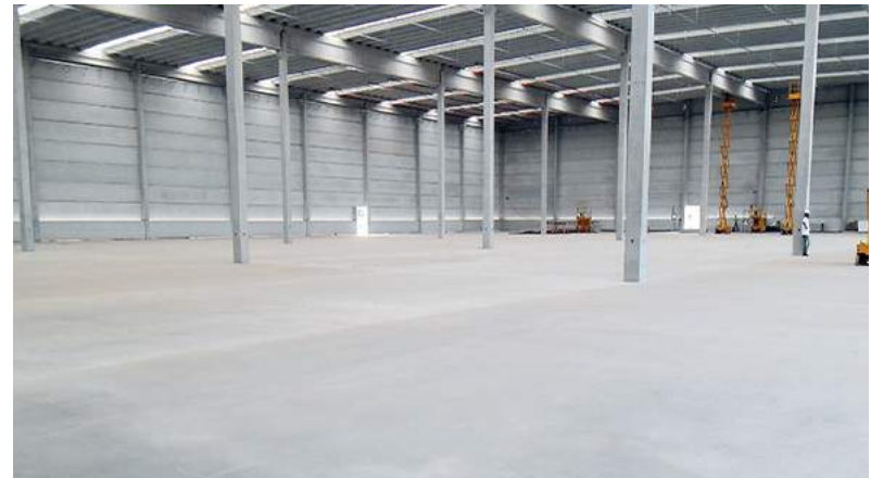
Piso fibro-reforzado con fibras de polipropileno FibroMac®
