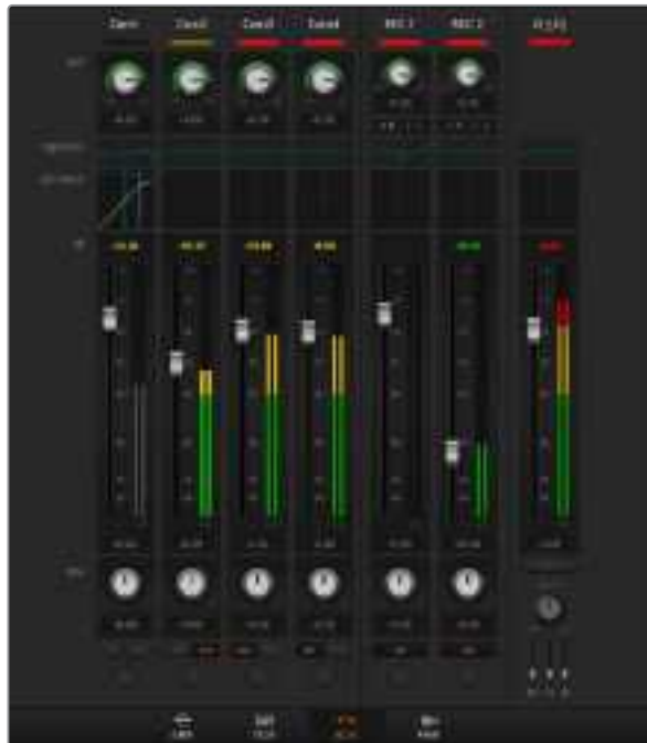
하드웨어 컨트롤 서페이스의 게인 페이더를 위/아래로 움직이면서 컴퓨터 화면의 소프트웨어의 오디오 믹서 페이더가 같이 움직이는지를 확인하세요.
