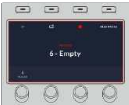
Durante a gravação, uma borda vermelha será exibida em torno do LCD.
