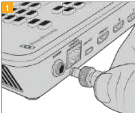
Stecken Sie das mitgelieferte Kabel in die Strombuchse am ATEM Mini
