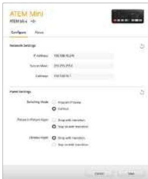
通过Blackmagic ATEM Setup软件的“配置”选项卡更改网络设置。
