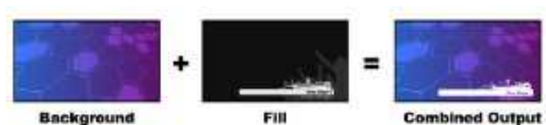
Combinación del fondo y el primer plano en una composición por luminancia
