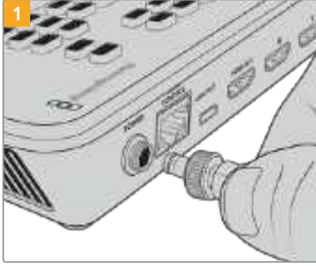
1 Kutuda gelen kabloyu kullanarak ATEM Mini'nin güç girişine elektrik bağlayın.
