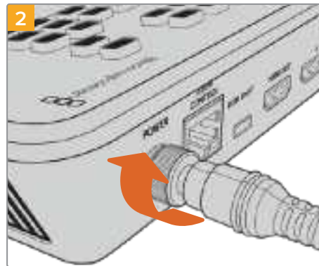
Sichern Sie die Kabelverbindung zum ATEM Mini, indem Sie den Verbinder am Gerät festziehen
