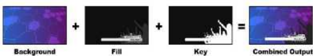
リニアキーを使用したバックグラウンドとフィル/キーの結合
