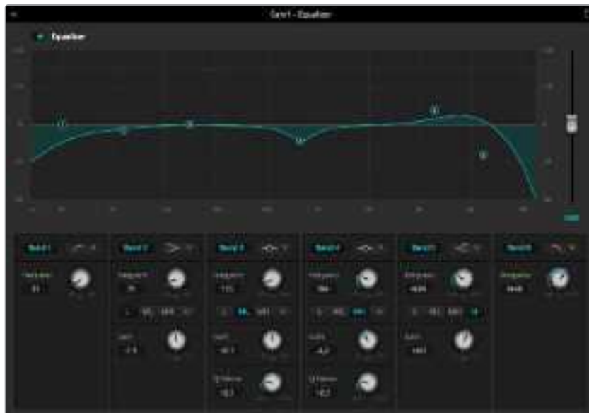
Jeder Audioeingang hat seinen eigenen parametrischen Equalizer mit 6 Bändern
