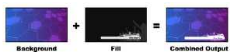
Kombination eines Hintergrunds mit Füll- und Stanzsignalen in Form eines Luma-Keys
