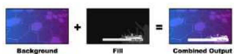
ルマキーを使用したバックグラウンドとフィル/キーの結合
