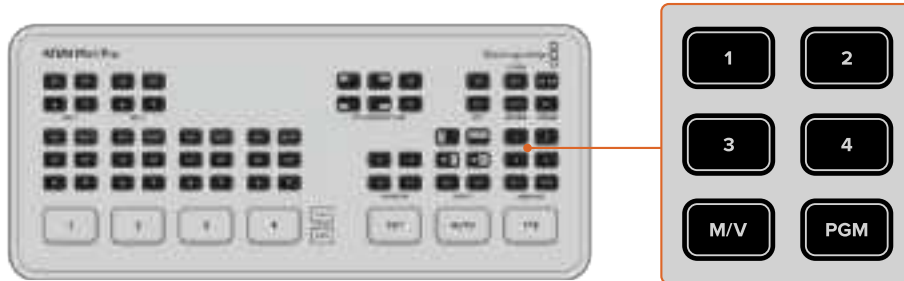
ビデオ出力ボタンを押して、HDMI出力のソースを切り替え。
