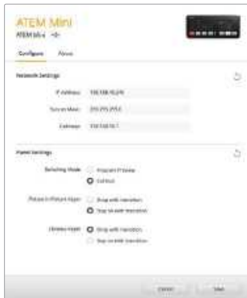
Blackmagic ATEM Setupの「Configure」タブでネットワーク設定を変更します。
