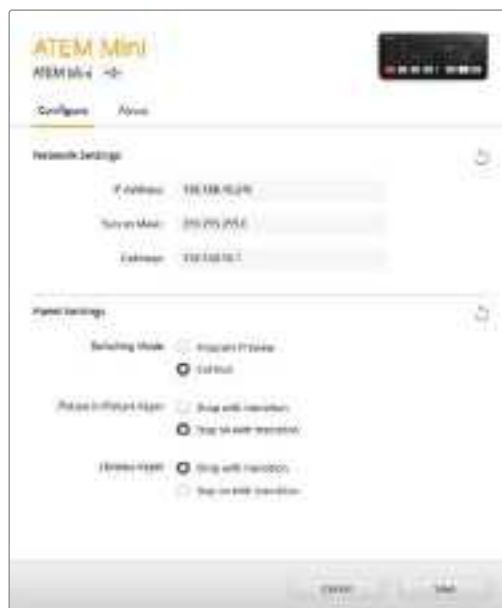
Ändern der Netzwerkeinstellungen über die „Configure“-Registerkarte in ATEM Setup
