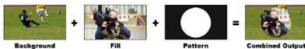
将背景和填充及图案键进行合成
