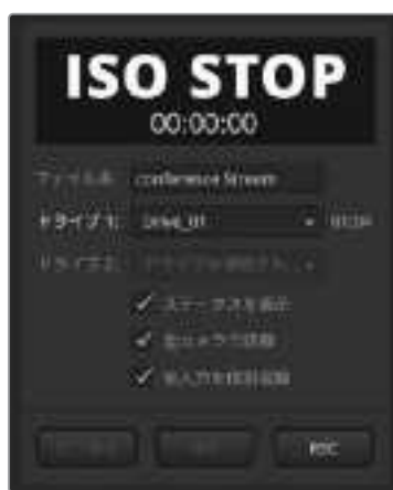
ISO (個別) 収録を有効にするには、「配信の収録」パレットで「全入力を個別収録」にチェックを入れます
