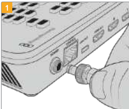
1 同梱のケーブルを使用して、ATEM Miniの電源入力に電源を接続。
