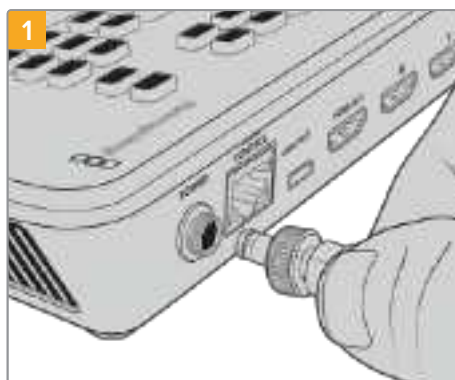
Conecte a alimentação usando o cabo fornecido.
