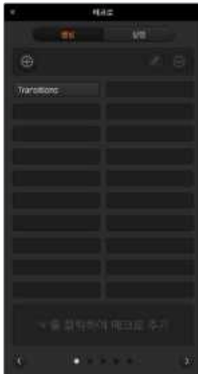
ATEM Software Control의 매크로 창에서 매크로를 녹화 및 실행할 수 있으므로 버튼 하나로 복잡한 스위치 액션 시퀀스를 손쉽게 반복할 수 있습니다.
