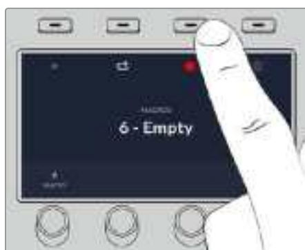
記録アイコンのソフトボタンを押して、マクロの記録を開始します。
