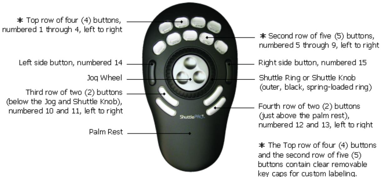
**Fig. 1-1** ShuttlePRO v2 Layout
